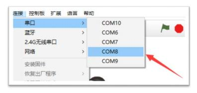
2. 主控板没有选择正确,请在对应菜单中选择正确的主控板
